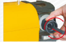
2 ลับมุมจิก Grind the point angle
