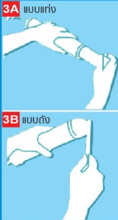
ดึงก้านอัดจาระบี (T-knob) จนสุดแล้วดึงสลักด้านข้าง ออกเพื่อให้ล็อก Draw the T-knob fully backward then latch side way.
