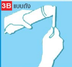
ดึงก้านอัดจาระบี (T-knob) จนสุดแล้วดึงสลักด้านข้าง ออกเพื่อให้ล็อก Draw the T-knob fully backward then latch side way.
