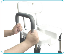
ประกอบที่พิงแขนกดพื้นลิ้นกเอาไว้ขณะเสียบที่พิงแขนลงให้ลงลิ้นก และแน่ใจว่าพินแดงออกมา
