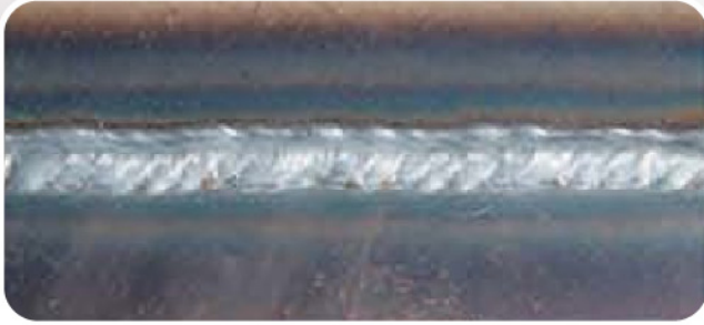
ผลการเชื่อมลวดใช้แก๊ส CO2 ขนาดลวดเชื่อม 0.8 มม. แผ่นเหล็กหนา 2 มม. Gas shielded welding 0.8 mm carbon welding wire 2 mm steel plate.
