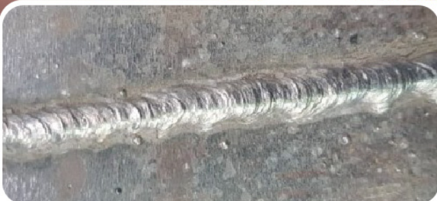
ผลการเชื่อมลวดฟลักซ์คอร์ไม่ใช้แก๊ส เหล็กคาร์บอน ขนาด 10 มม. ความเร็วลวด 7 เมตร/นาที Gasless welding Carbon steel 10 mm, wire speed 7m/min
