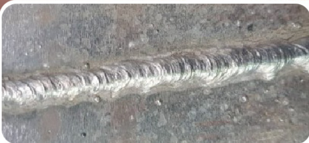
ผลการเชื่อมลวดฟลักซ์คอร์ไม่ใช้แก๊ส เหล็กคาร์บอน ขนาด 10 มม. ความเร็วลวด 7 เมตร/นาที Gasless welding Carbon steel 10 mm, wire speed 7m/min
