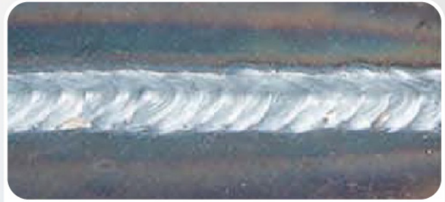
ผลการเชื่อมลวดใช้แก๊ส CO2 ความเร็วลวด 6 เมตร/นาที ปรับเชื่อมเกล็ดปลา +5 Gas shielded welding Wire speed for 6 mm/min, inductance +5
