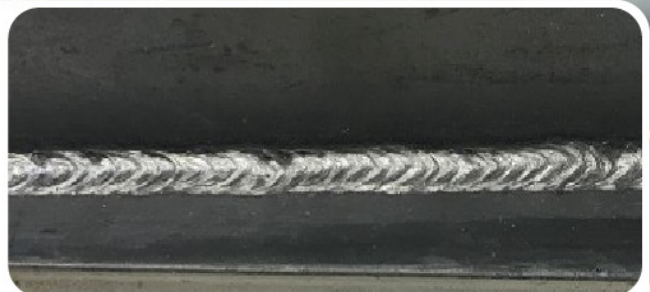
ผลการเชื่อมลวดฟลักซ์คอร์ไม่ใช้แก๊ส เหล็กคาร์บอน ขนาด 10 มม. ความเร็วลวด 7 เมตร/นาที Gasless welding Carbon steel 10 mm, wire speed 7m/min
