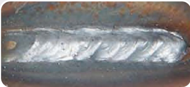
ผลการเชื่อมลวดใช้แก๊ส CO2 ความเร็วลวด 6 เมตร/นาที ปรับเชื่อมเกล็ดปลา -2 Gas shielded welding Wire speed for 6m/min, inductance -2
